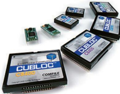
PCB 를 제작할 능력이 없는 분이라면, 두가지 선택이 있습니다. 우선 큐블록 MSB 시리즈입니다. 이미 제작된 모듈형태의 CUBLOC 이므로 곧바로 현장에서 설치 사용할 수 있습니다.
